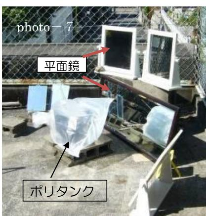
Fig.-1 太陽熱と鏡で水の加熱
